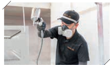
塗装作業(溶剤塗装)の様子
