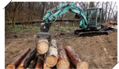
重機による木材の集材作業
