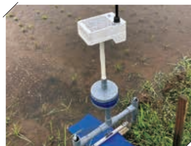
自動で圃場に給水するケート、スマホで水位がわかるセンサー
